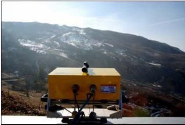
写真 1 IBIS-L の電波の送受信部と対象斜面
