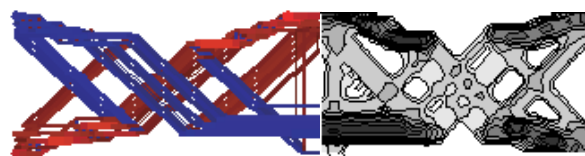
図 1 位相最適化による骨格形態形成の解析結果 (20×80 分割)
