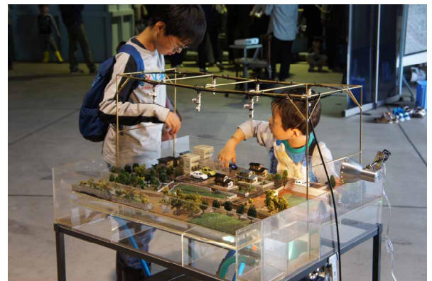
写真1 都市域の氾濫を表わすミニチュア模型
