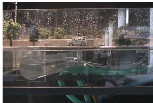
写真3 地下調節池での雨水貯留の様子
