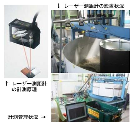
図-2 緩衝材製作用転圧装置 図-3 緩衝材表面高さの計測システム
