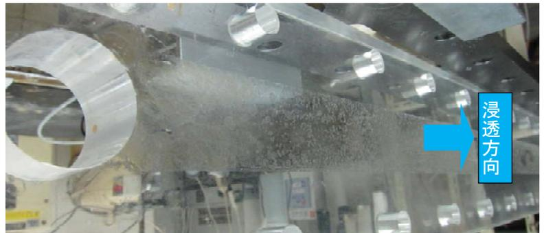
写真-3 スリット内のゲル化状況 (溶液型)
