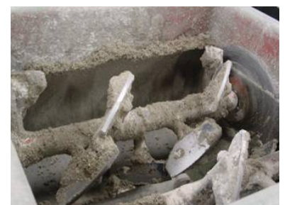
(c)攪拌羽根・軸への付着状況 写真-1 二軸強制練りミキサによる混合土の製造例
