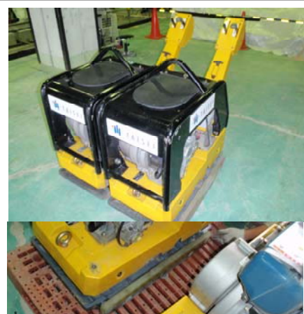
図 2-3: 改良プレートコンパクタ
