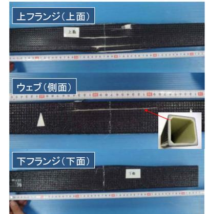
上フランジ座屈応力度は、パイプの曲げ破壊応力度に近く、上フランジの座屈がパイプ全体の破壊現象を支配しているものと考えられる。ただし、上フランジ座屈応力度がやや高い値を示しており、これは載荷板のエッジ部での応力集中などが一つの要因であろうと推察される。
