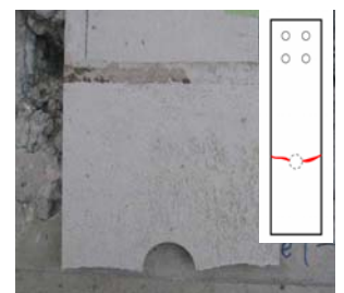
写真-2 FRP の破断状況
