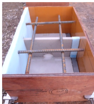
写真1 H-H-A 供試体型枠
