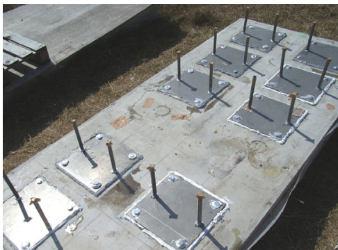
写真-1 再劣化を再現した供試体
