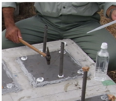
写真-5 滞水状態のつくり方
