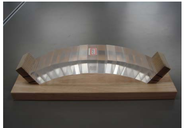
図4. 円弧近似によるアーチ橋の模型
