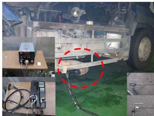
写真-1 簡易排出ガス測定状況
