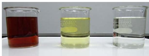
図-4 MF 処理水 (左)、UF 処理水 (中)、NF 処理水 (右)
