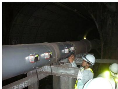
写真1 超音波流量計設置状況
