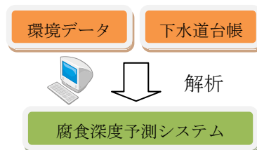
図3 腐食深度予測機能の流れ
