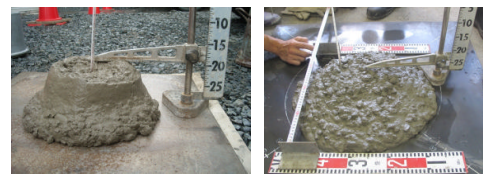
図-2 スランプ・スランプフロー状況 （左側①配合、右側②配合）
