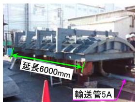
写真-1 天端部模擬型枠の外観
