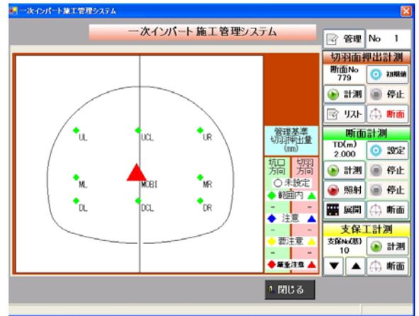
図2 「切羽面計測」モードでの計測画面
