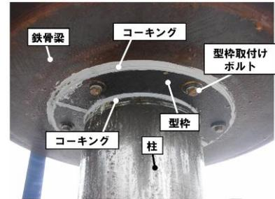
図 5 試験状況 (試験体1 水張試験)
