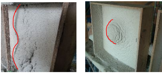
(a) ロータリー式吹付け (b) エア－吹付け 写真-2 吹付け後の外観
