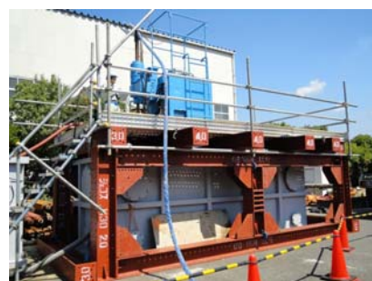
写真-1 切削試験状況
