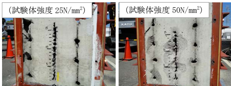
写真-2 切削試験（両側：位置固定，中央：スリット状）
