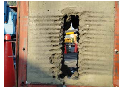
写真-4 切削試験（両面放射切削）
