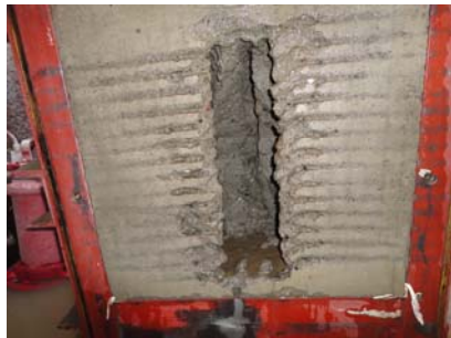
写真-3 切削試験（片面放射切削）
