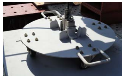
写真-7 ターンテーブル
