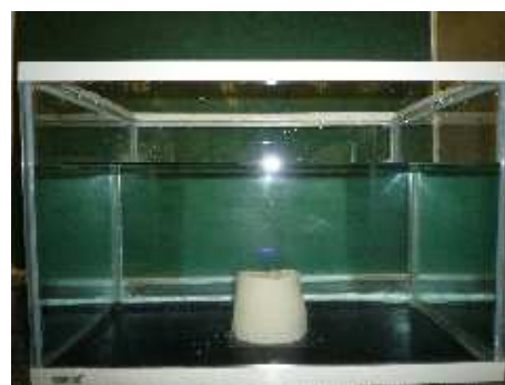
写真-2 水中不分離抵抗性確認試験例(配合Ⅱ)
