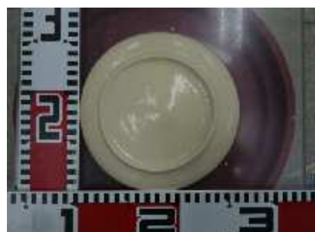
写真-1 スランプフロー試験例(配合Ⅰ)
