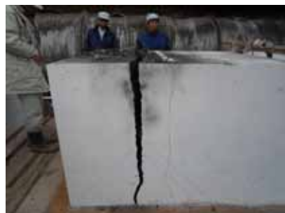
写真-3 鉄筋コンクリート試験体の破断状態
