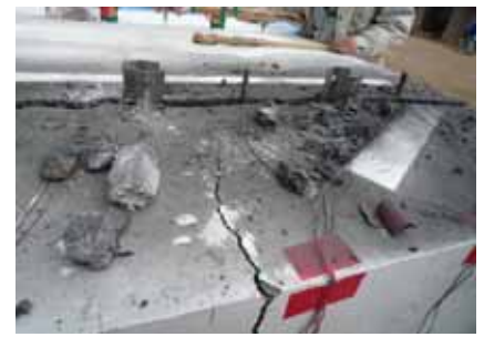
写真-4 RC試験体の自由面側に生じた亀裂
