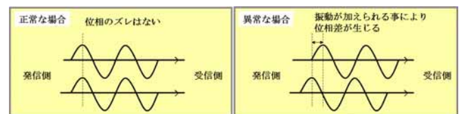
図-2 振動検知の原理
