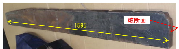
図-2 破断したフェイスプレート
