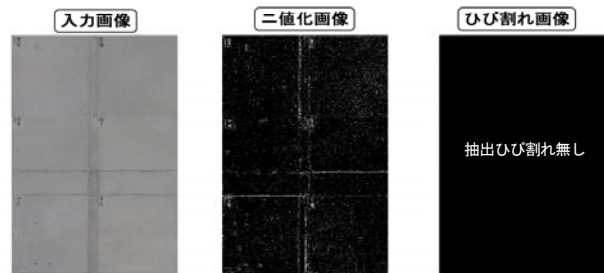
図-5 橋長中央部の撮影画像処理
