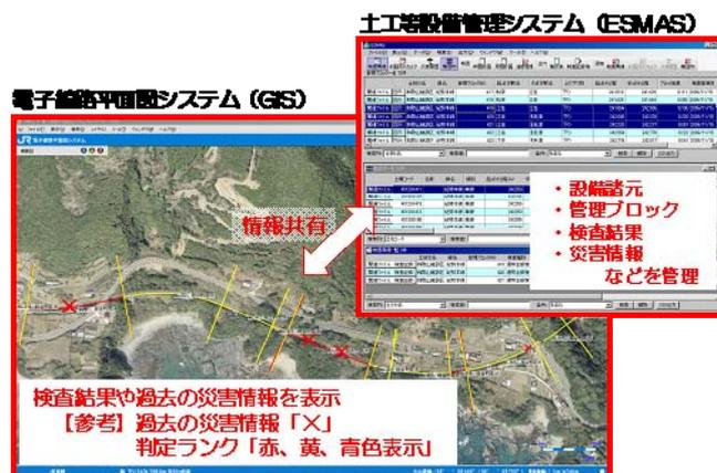
図3 他システム(電子線路平面図システム)連携
