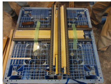
写真2 鉄筋設置状況 (測定する鉄筋の下に直交してに設置)
