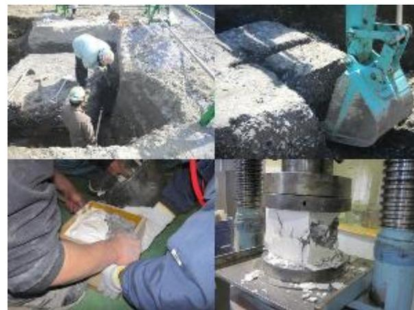
写真-5 試料採取・圧縮試験
