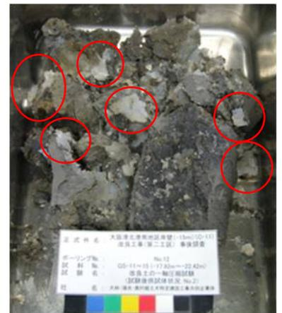
写真-1 qu 試験後の試料内部
