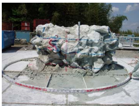
(b) 捨石護岸の間隙充填 (左: 全体, 右: 間隙部)
