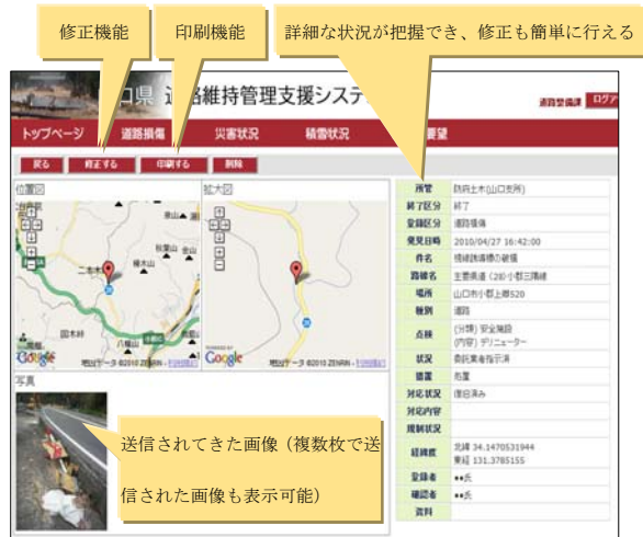
図-4 道路施設損傷情報の詳細画面
