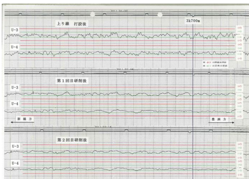
図-4 走行路高低測定結果
