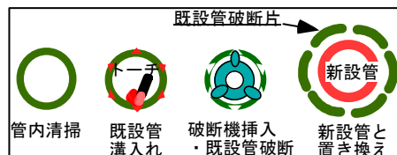
図-1 プラズマモール工法概念図
