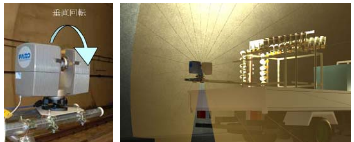
図-3 ヘリカルスキャナの外観と搭載イメージ
