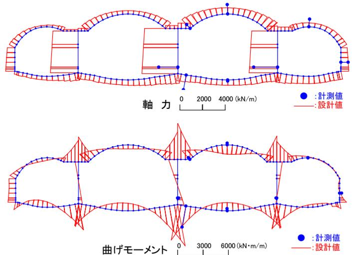
図-6 設計値の比較 荷重条件：計測土圧
