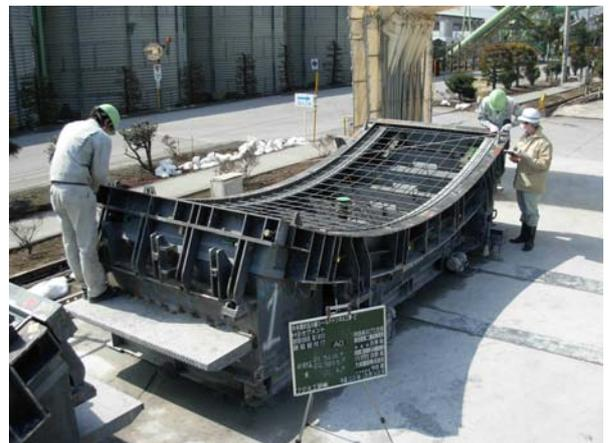
写真-1 鋼殻組付検査状況
