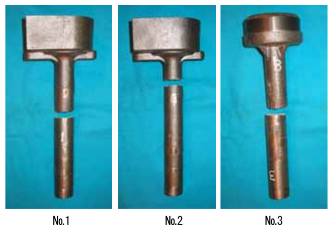
写真-5 破断状況
