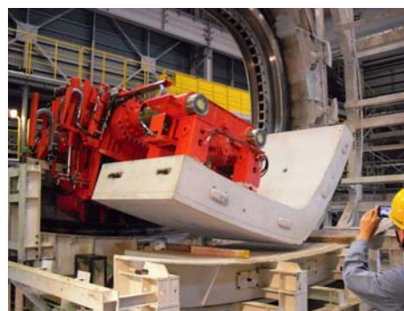
写真-1 隅部セグメント把持状況
