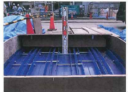
写真-3 充填材の充填性確認用試験体
