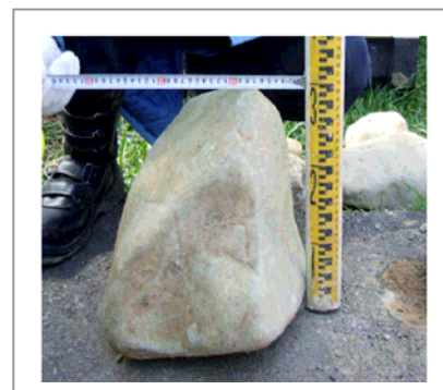
写真-3 立坑掘削時の巨礫 (400×300×300mm)
