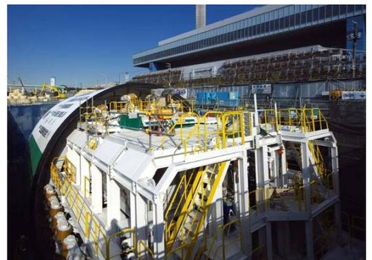
写真-1 後方設備一体型シールド
