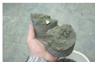
写真-4 造成の改良体
