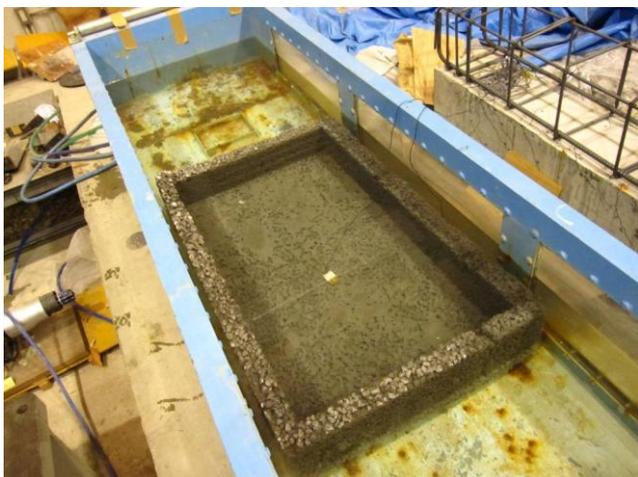
写真-1 囲いを設置した PoC 板
