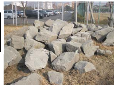
写真-8 製作した人工捨石
