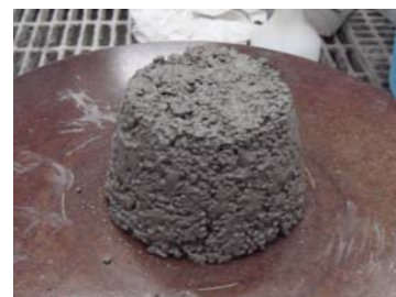
写真-1 フロー試験後の状況
