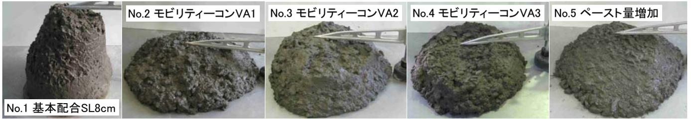
写真1 各種コンクリートのスランブ試験状況
