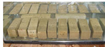
写真 1 多孔質ポリマーモルタルの水浸状況
