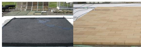
アスファルト標準舗装 保水性ブロック舗装
