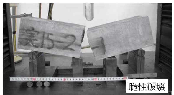
写真-2 供試体破断後（VF 無し）
