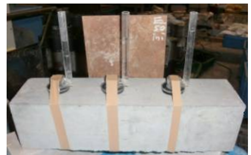
図-6 吸水量測定の様子
